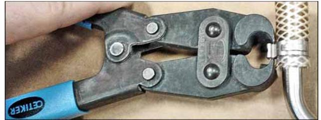
Figure 6-5 - Hose Clamp Removal (Oetiker Tool)
